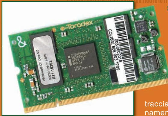
▲ La chiave contiene al suo interno un processore XScale da 520 MHz.
